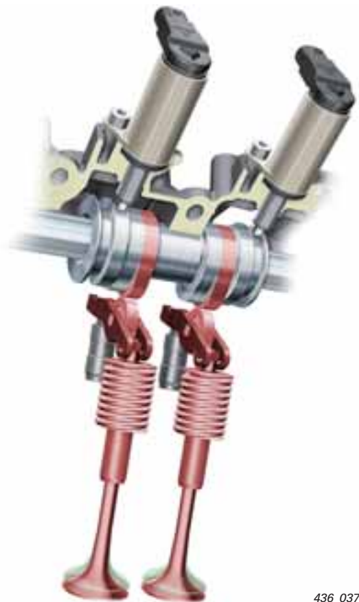
große Nockenbahnen (hohe Drehzahlen)
