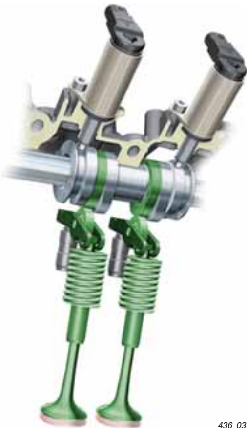
kleine Nockenbahnen (niedrige Drehzahlen)
